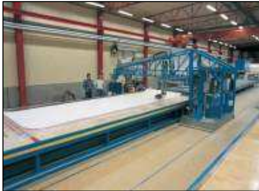
SikaForce® 7710 L100 Автоматическое нанесение при пр-ве стеновых и половых сэндвич панелей
