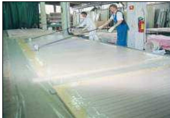
SikaForce® 7710 L100 Ручное (с помощью валиков) нанесение материала на поверхность, размещенную на вакуумном столе.
