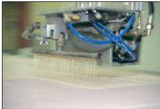
SikaForce® 7710 L35 Автоматическое нанесение при пр-ве стеновых и половых сэндвич панелей
